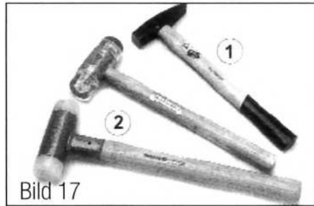
Bild 17 (1) Schlosserhammer, (2) Kunststoff- oder Gummihammer.
