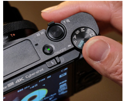
▲ Auf der Rückseite der Kamera findet der Daumen durch eine kleine Wulst guten Halt. Der Handballen wird auf diese Weise vom Gehäuse weggeführt und das versehentliche Drücken der darunterliegenden Tasten vermieden
