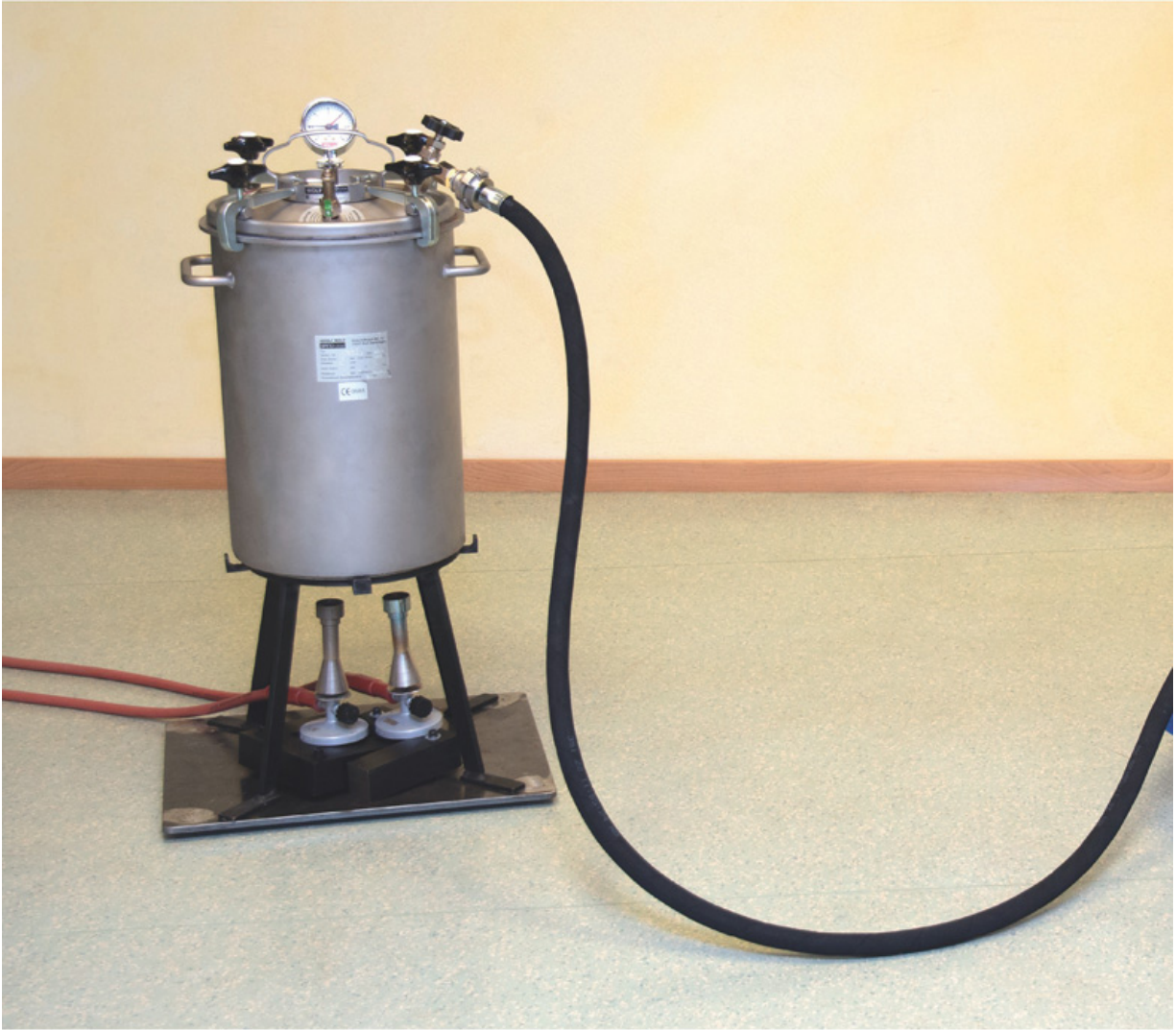
Abb. 1 Aufbau des Versuchs mit Dampfheber, Wanne unter dem Ablasshahn des Dampfhebers, Dampfschlauch, Dampfkessel, Vierfuß und Teclubrennern.
