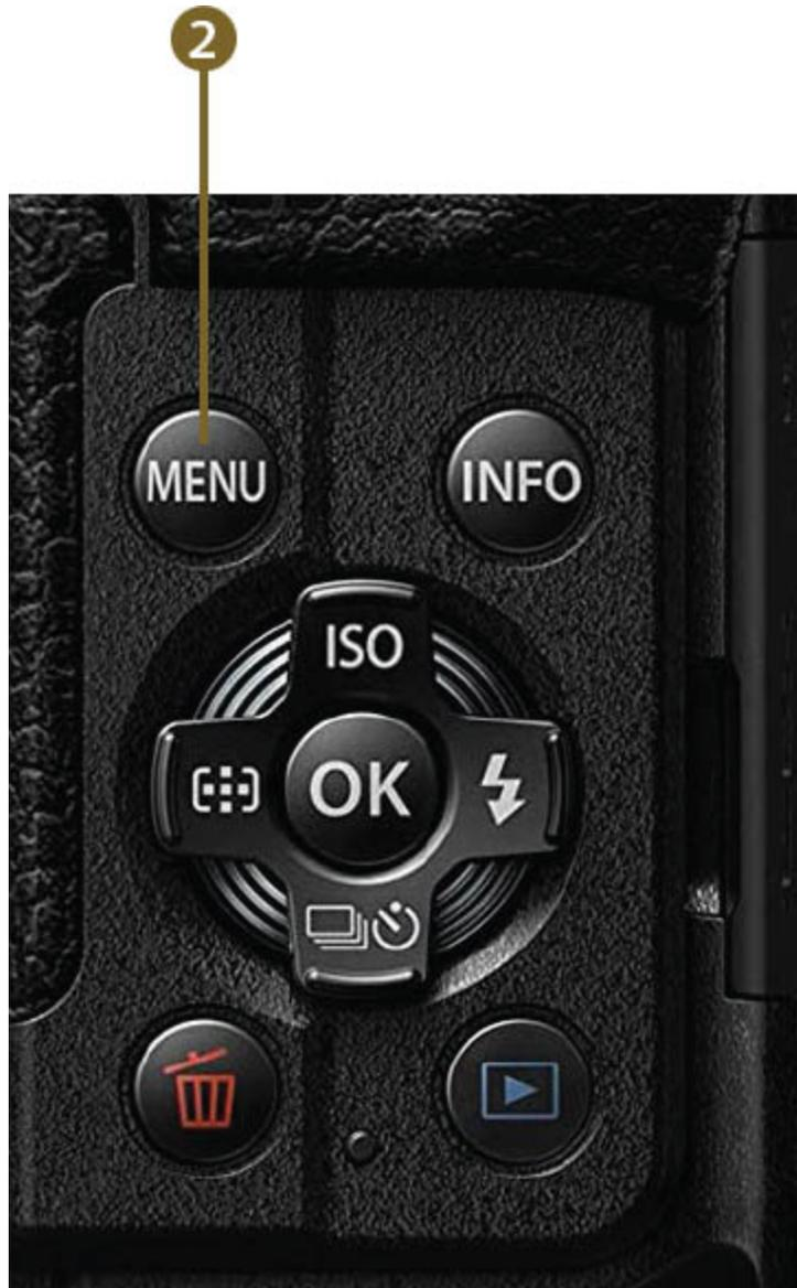
Abbildung 1.8: Die »OK«-Taste und die Tasten ISO, [•••], [L], [P] und [⚡] dienen zum Bestätigen von Einstellungen und zur Navigation in den Menüs, die »MENU«-Taste 2 zur Auswahl des Einstellungsmenüs (Bild: Olympus).
