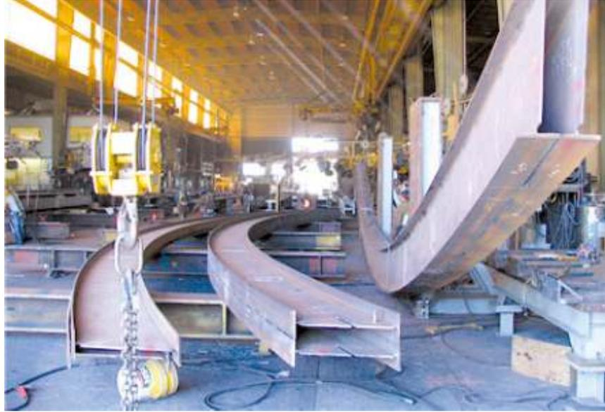
*Perfil de grandes dimensiones obtenido mediante armado*
