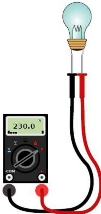
El multímetro también permite la medida de la continuidad de los conductores, posibilitando de esta manera verificar que no hay cortes en estos, así como verificando que no hay cortocircuito entre los diversos conductores de la instalación.
