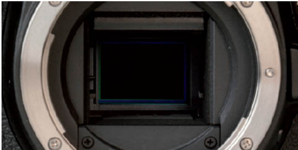
El espejo principal levantado deja ver el sensor
