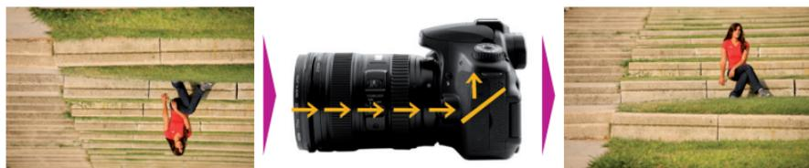
3. Por último, la imagen se proyecta en un segundo espejo alojado en la parte superior de la cámara donde se voltea en vertical para, finalmente, proyectarse en un tercer espejo enfrente al visor, que te permite observar la imagen tal y como es en origen. Este conjunto de espejos se denomina pentaprisma.
