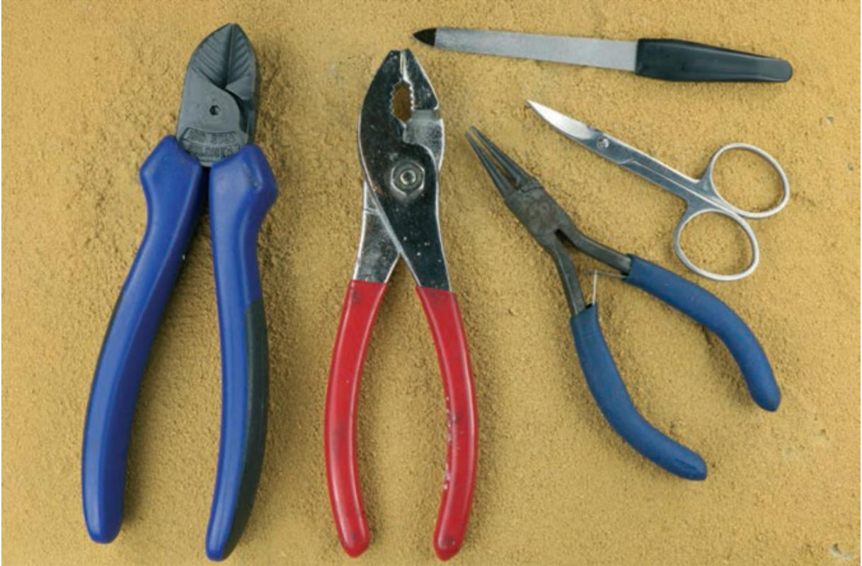
*Von links: Seitenschneider, Flachzange, Rundzange, Nagelschere und Nagelfeile.*
