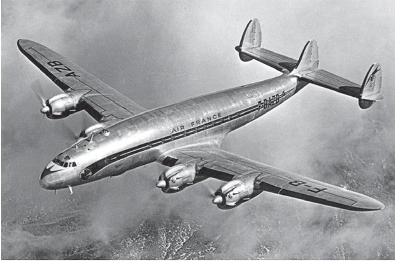
Lockheed L-049 Constellation matrícula F-BAZB de Air France, fotografiado en vuelo en junio de 1946. El Constellation, diseñado en la preguerra, se convirtió en un auténtico éxito en la posguerra debido a su velocidad de casi 550 kilómetros por hora y su alcance de 8.700 kilómetros. (R.A. Scholefield)
