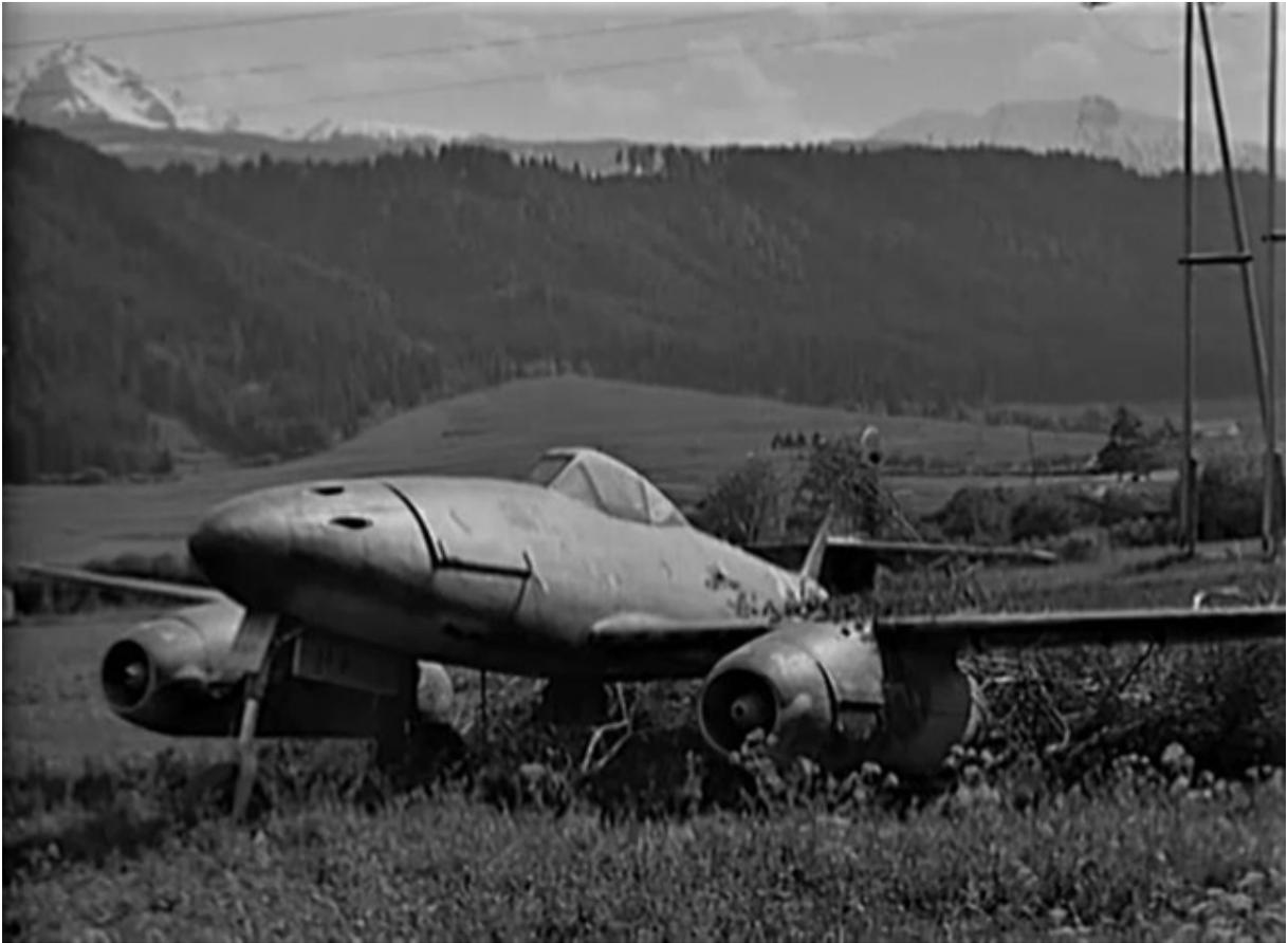
**Abbildung 3: Jagdflugzeug mit Strahltrieb Typ "Messerschmidt (Me) 262" auf dem Gelände des Flugplatzes Innsbruck-Kranebitten. Ab Bug erkennbar zwei der insgesamt vier Mündungsschlitze der 30-mm-Schnellfeuer-Bordkanonen. Foto. Still Picture aus US-National-Archives (NARA), Film ID 111-adc-4524, public domain.**
