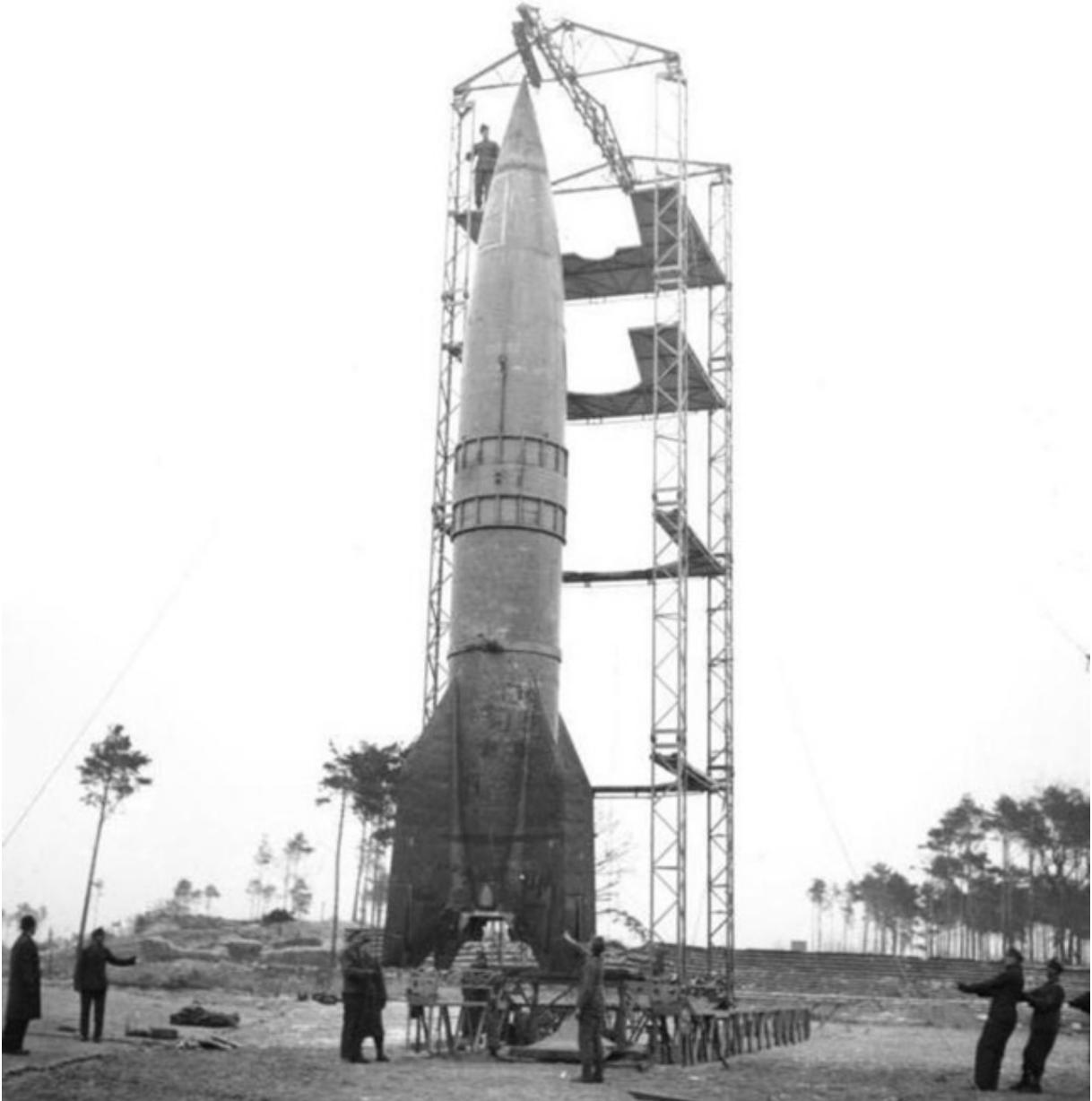
**Abbildung 4: A4-Rakete (V 2 genannt), 14 Meter hoch, knapp 13 Tonnen schwer, Reichweite über 300 km, Nutzlast 750 kg (Sprengstoff), Gipfelhöhe der Flugbahn: 80 km. Foto: BArch RH8II Bild-B2055-44, Lizenz CC-BY-SA 3.0.**
