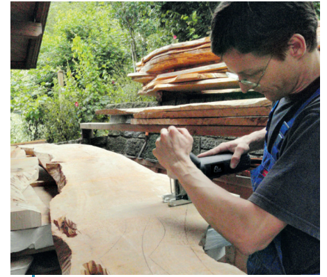
5 | Für Arbeiten außerhalb der Werkstatt wie hier das grobe Ausschneiden sind Akku-Geräte am besten geeignet.
