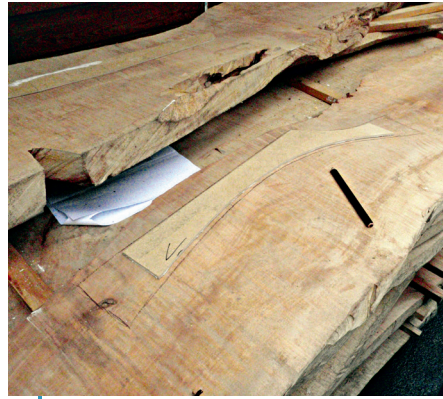
4 | Geben Sie beim Anzeichnen – hier deutlich zu sehen – viel Längenzuschlag. Tipp: Wenn der Maserverlauf der Blockware schlecht zu erkennen ist, diesen mit einem Putzhobel etwas freilegen.
