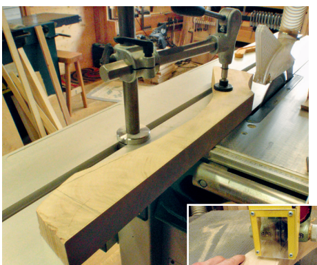
9 | Schneiden Sie zunächst an der Bandsäge den inneren Bogen die Beinteils aus. Die Leimfuge schneiden Sie nun gerade an, mit etwas Übermaß zum Abrichten. Das Schneiden geht übrigens mit Handkreissäge und Schiene auch sehr gut.
