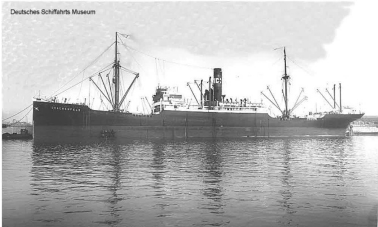
Drachenfels , die 3. dieses Namens, 6.342 BRT, erbaut bei den Howaldtswerken, Kiel, eine 3-Zylinder-Dampfmaschine; Stapellauf im Juni 1921. Ladung auf der letzten Reise: insgesamt 7.815 tons bestimmt für Belgien, Deutschland und Dänemark
