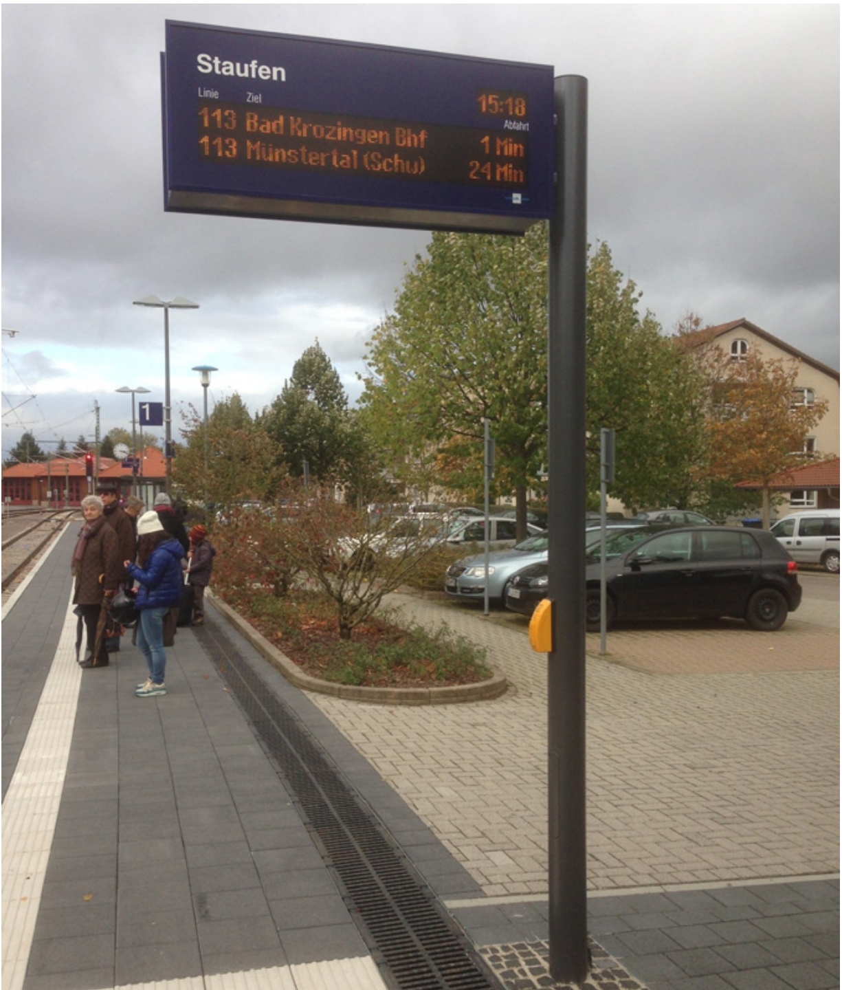
Abbildung 3: DFI-Anzeiger mit Taster für akustische Ansage
