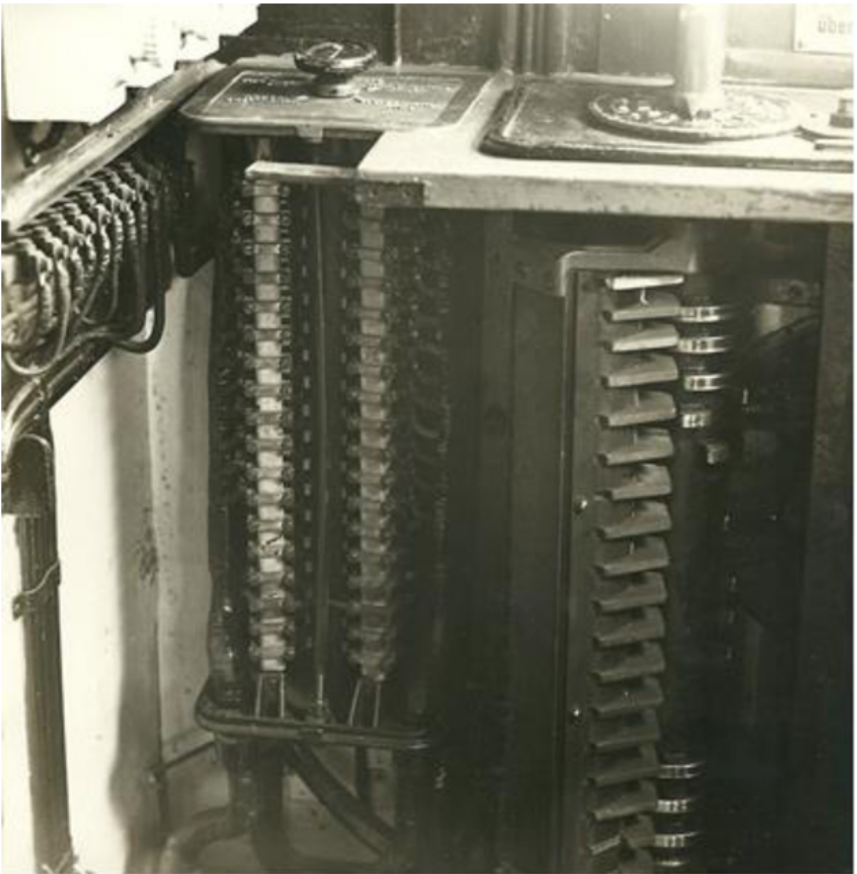
Geöffneter Fahrschalter (Archiv Hochbahn)
