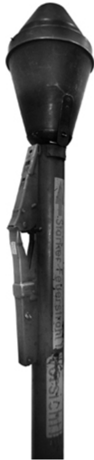
Abb. 6: Die Panzerfaust 60 – sie konnte auf Entfernungen bis 60 Meter sinnvoll eingesetzt werden. Der Volkssturm erhielt sie in großen Stückzahlen.
