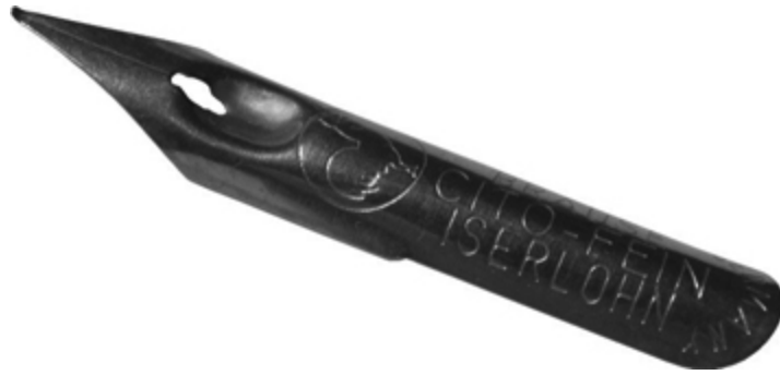
Bild 4: Stahlfeder mit wannenförmigem Tintenspeicher hinter dem Federauge, der mit dem Federauge verbunden ist. So gesehen ist dies die simple Variante eines Füllfederhalters.
