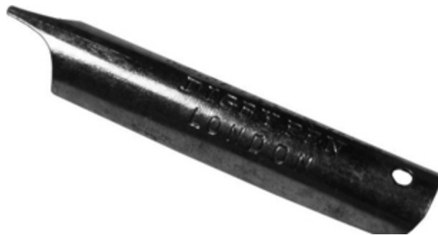
Bild 5: Manch alte Metallfeder kannte weder Tintenwanne noch Federauge. Beim Dippen der Feder in Tinte sollte ein Tintentropfen im Inneren der gewölbten Feder anhaften, idealerweise dort, wo die Flügelschenkel sich zu spalten beginnen.
