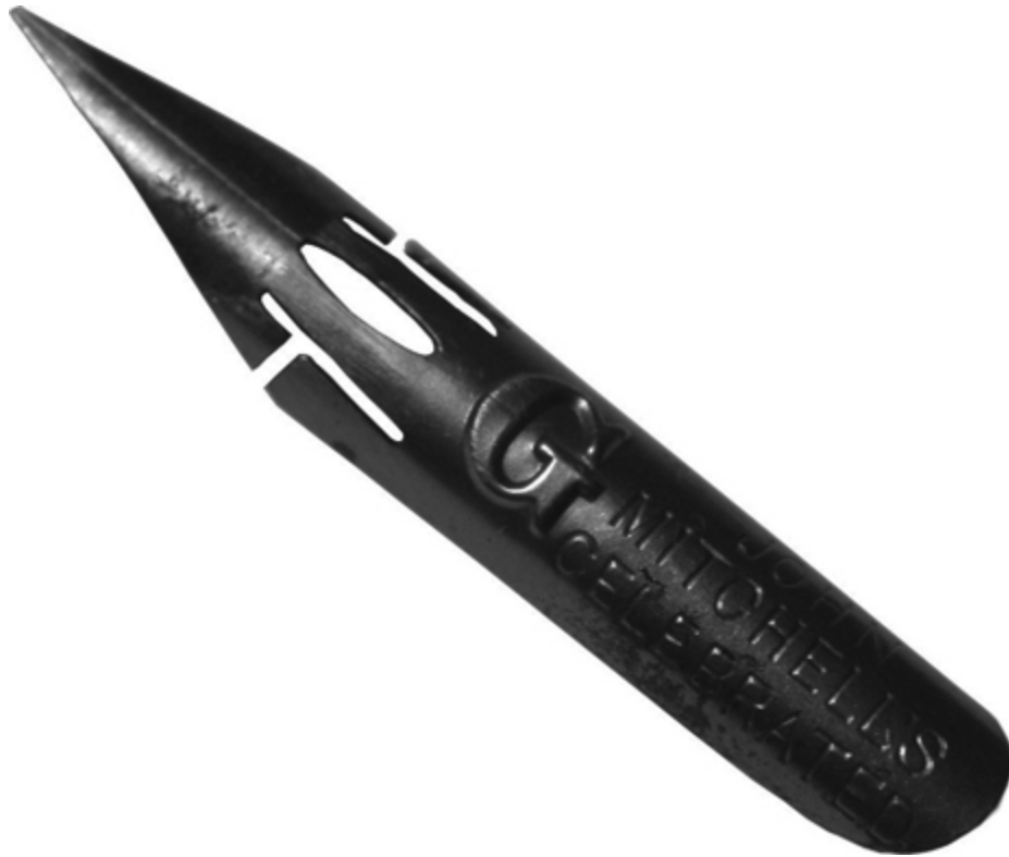
Bild 6: Alte Metallfedern, wie diese hier von Mitchells aus der Mitte des 19. Jh., wurden sehr aufwendig fabriziert und verziert. Sie hat ein langgezogenes ovales Federauge. Seitlich gibt es Aussparungen im Metall, um die Flexibilität zu erhöhen und flexibles Schreiben zu erleichtern.
