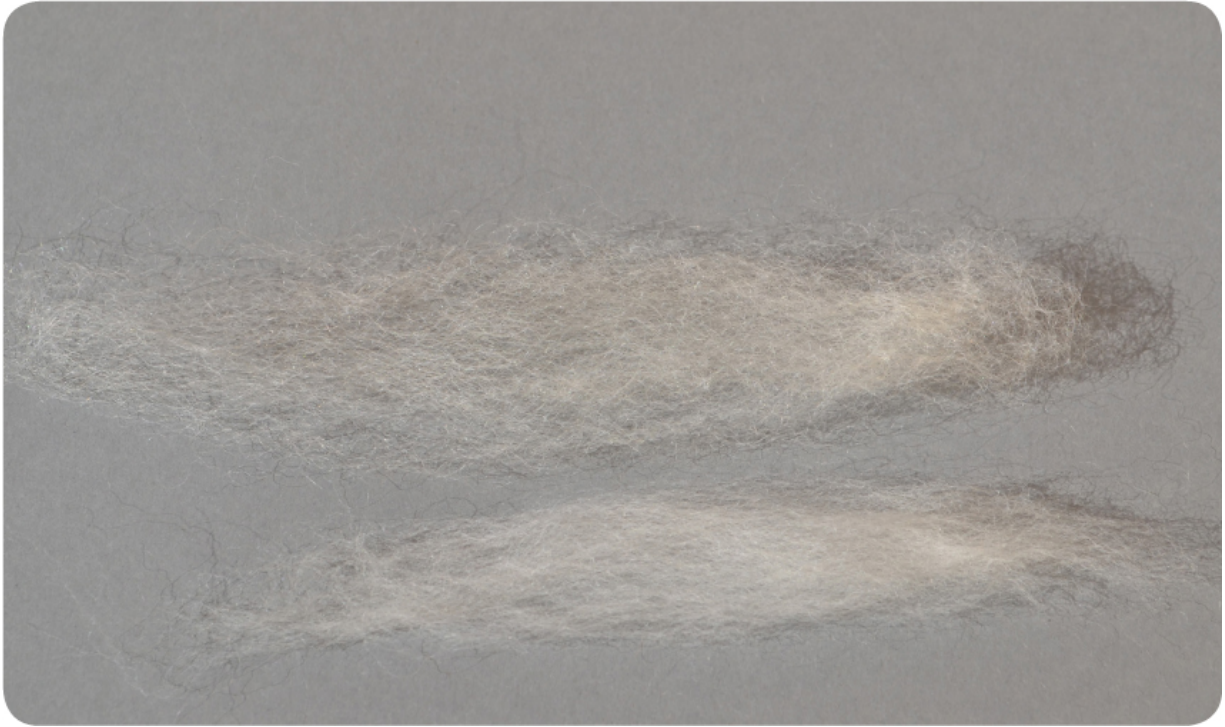
Fasern mit unterschiedlichen Stapellängen (oben Milchscharf, unten Merino)
