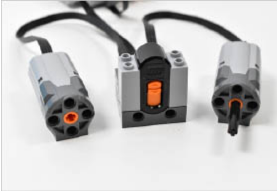
Zwei Power-Functions-Motoren nehmen einen Infrarotempfänger in ihre Mitte.
