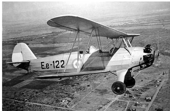
Una de las primeras producciones masivas de aeronaves de la Fábrica Militar de Aviones fue el entrenador alemán Focke-Wulf FW-44J Stieglitz, fabricado a partir de 1936. Se produjeron 197 ejemplares hasta 1943 cuando la importación de insumos se hizo imposible por la Segunda Guerra Mundial. (Archivo General de la Nación)
