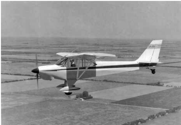
Los hermanos Héctor y César Boero ya tenían bastante experiencia en la fabricación de aviones cuando, en 1970, se publicitaron las medidas de promoción y fomento industrial. Desde un humilde hangar en la localidad de Morteros (Córdoba) se plegaron al programa con los biplaza monomotores de su diseño Aero Boero AB-95, AB-115 y AB-180. La fotografía muestra el AB-180 RVR (Remolcador con Visión Retroscópica) LV-JZU, serial 13. ( Aero Boero )
