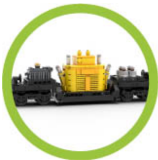
Tiefladewagen mit Transformator als Ladegut
