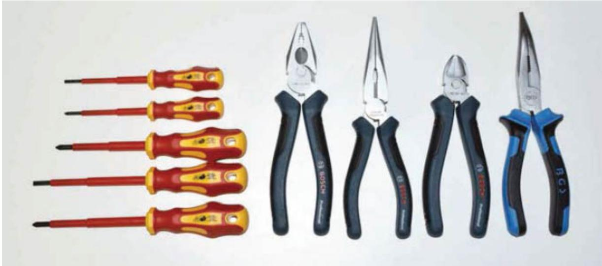
Für Arbeiten an elektrischen Anlagen sind ausnahmslos intakte isolierte Werkzeuge zu verwenden.
