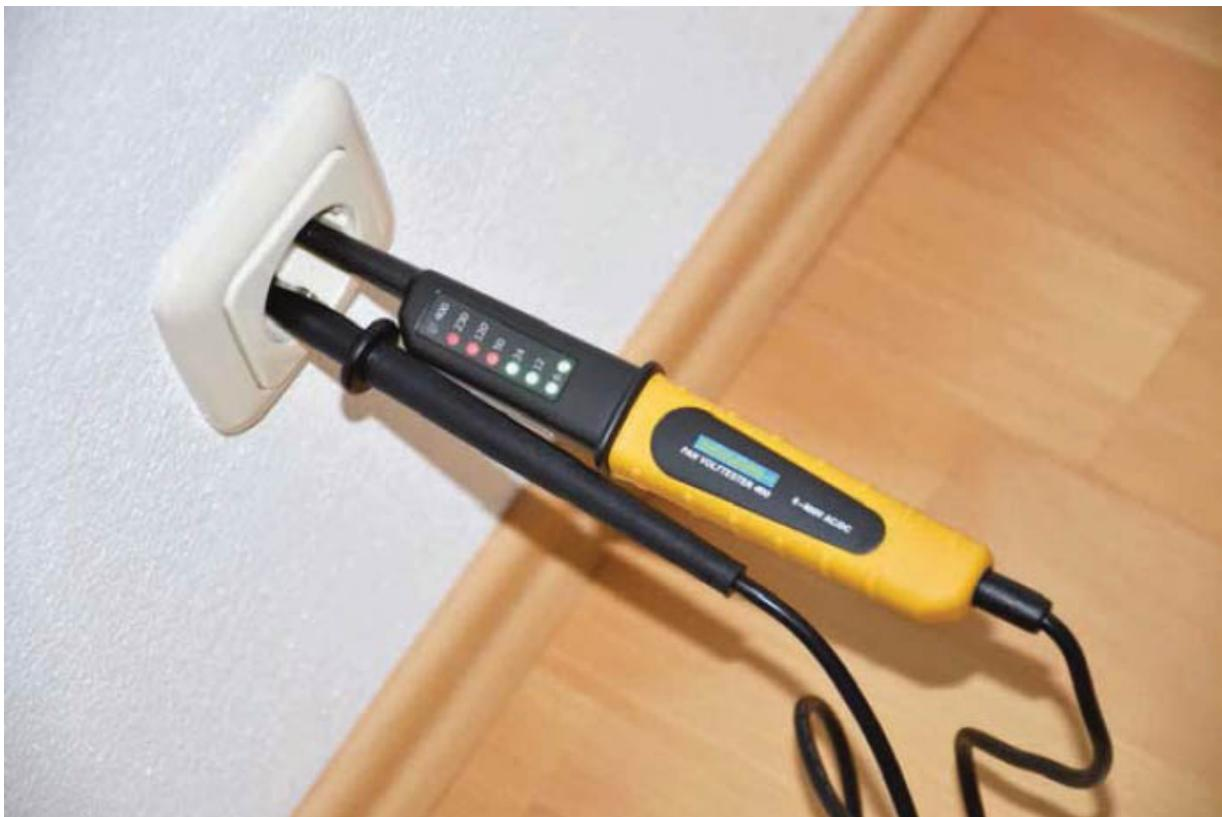
Einfache Spannungsprüfer zeigen anhand einer LED-Reihe das ermittelte Spannungsniveau an.
