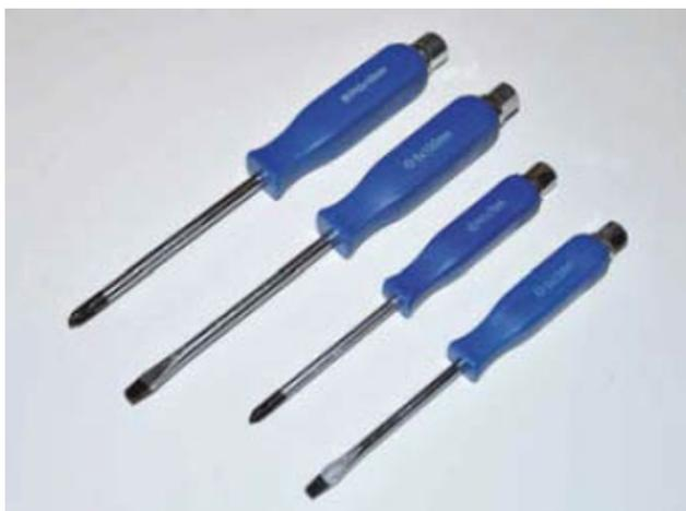
Nicht isoliertes Werkzeug wie diese Schraubendreher haben bei Arbeiten an elektrischen Anlagen nichts zu suchen.
