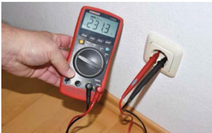
Nur wenn das Instrument auf Wechselspannung eingestellt ist, siehe AC-Zeichen im Display, misst es die korrekte Spannung.
