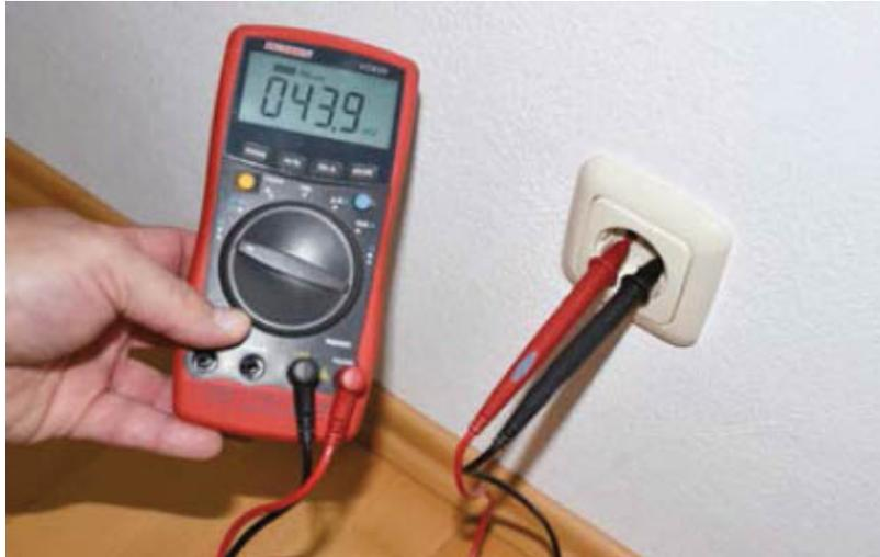
Ist das Multimeter fälschlicherweise auf Gleichspannung eingestellt, zeigt es bestenfalls eine Spannung von wenigen Millivolt an.
