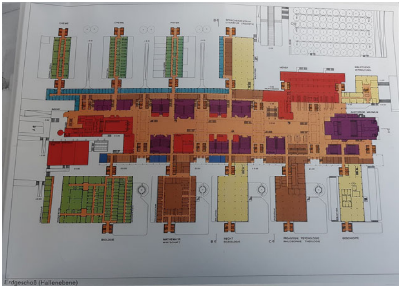
Abb. 2 Das Erdgeschoss der Universität Bielefeld in der Bauplanungsdokumentation: Die zentrale Halle (orange) verbindet alle Fakultäten und Fachrichtungen miteinander. © Foto. Universität Bielefeld
