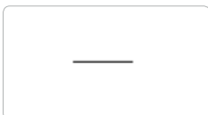
Bild 1.16: Das Schaltzeichen eines elektrischen Leiters ist eine Linie.
