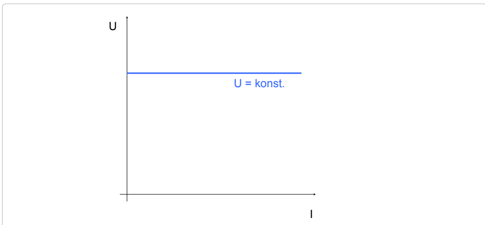
Bild 1.1: Das Diagramm zeigt das Strom-Spannungs-Verhältnis einer idealen Spannungsquelle.
