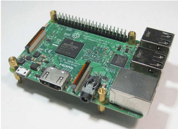
*Abbildung 3.4: Das Raspberry Pi Board*
