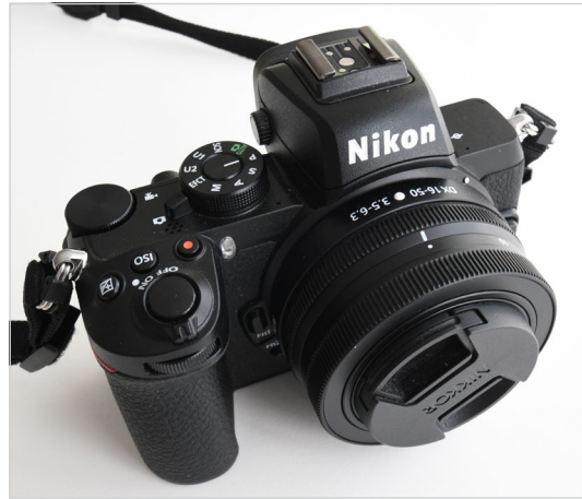
Abb. 2.6 Zum Fotografieren bereit ist alles, wenn der weiße Punkt auf der Oberseite des Objektivs mittig unter dem Nikon-Schriftzug (»auf zwölf Uhr«) eingerastet ist. Achten Sie darauf, dass Sie Ihre Kamera und Objektive immer mit einem Deckel schützen, wenn Sie nicht fotografieren.
