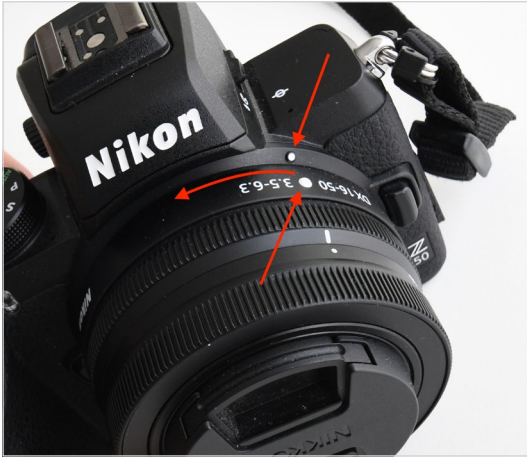
Abb. 2.5 Setzen Sie das Objektiv so an die Kamera, dass das Objektiv glatt auf dem Bajonett aufliegt und die weißen Punkte von Objektiv und Kamera-Objektivring einander gegenüberliegen. Dann drehen Sie das Objektiv gegen den Uhrzeigersinn (von der Frontseite aus gesehen), bis es einrastet.
