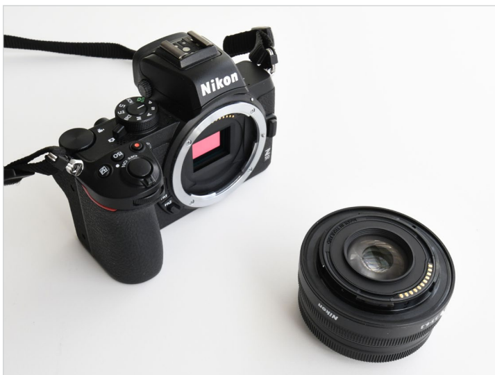
Abb. 2.4 Nehmen Sie die Deckel von Kamera und Objektiv ab. Im Kamerainneren erkennen Sie hinter dem Bajonettring den Sensor. Da dieser und die rückwärtige Linse des Objektivs empfindlich auf Staub reagieren, sollten Sie beim Objektivwechsel zügig, aber ohne Hektik vorgehen.
