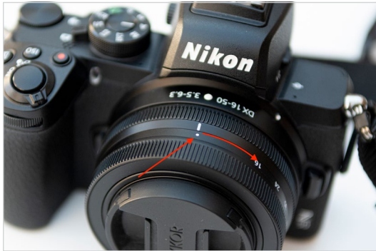
Abb. 2.7 Das Objektiv ist verschlossen. Drehen Sie es in Pfeilrichtung auf die »16«. Zu Beginn überwinden Sie einen leichten Widerstand, ...
