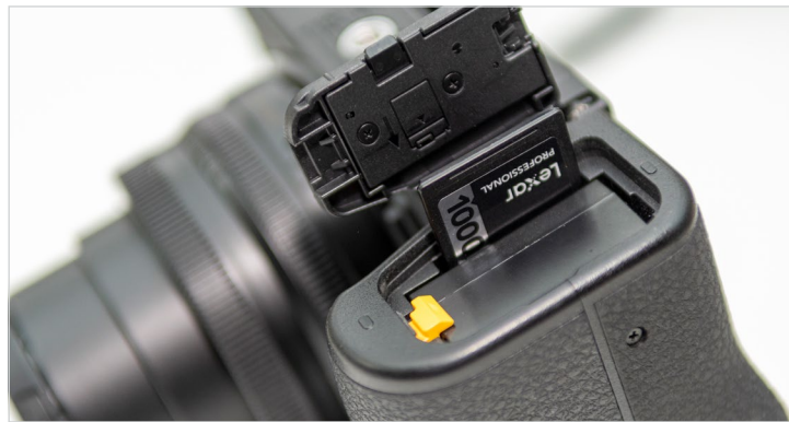
Abb. 2.3 Der SD-Slot liegt unter der Klappe des Akkufachs. Schieben Sie die SD-Karte mit der abgeschrägten Kante nach links unten bzw. mit dem Etikett zum Akku hin in das Fach, bis sie einrastet. Zum Herausnehmen drücken Sie die Karte leicht in das Fach, damit sich die Arretierung löst und Sie die Karte herausziehen können.
