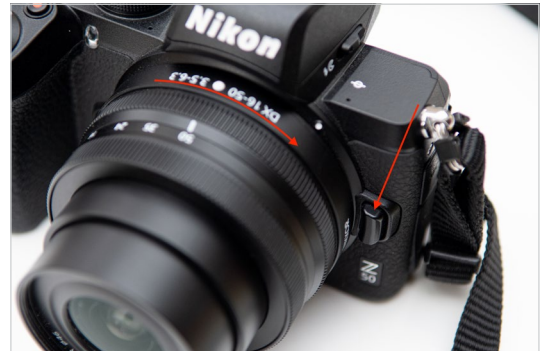
Abb. 2.10 Drücken Sie erst die Bajonettverriegelung und drehen dann das Objektiv im Uhrzeigersinn, um es abnehmen zu können.
