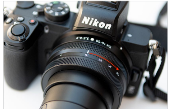
Abb. 2.8 ... auf der »16« rastet das Objektiv dann ein und ist aufnahmebereit. Durch Drehen in Pfeilrichtung fahren Sie den Brennweitenbereich ab, vom Weitwinkel zum leichten Tele ...
