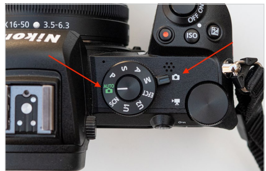
Abb. 2.13 Funktionswählrad auf »AUTO«, Foto-/Film-Wähler auf Foto-Modus – mit diesen Einstellungen können Sie loslegen.
