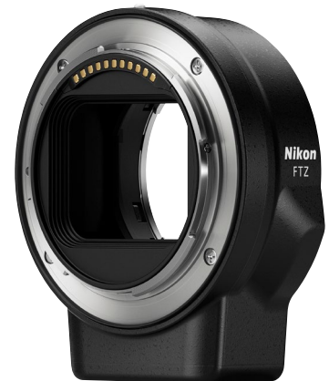
Abb. 1.4 Der FTZ-Adapter sorgt für Kompatibilität zwischen den Z-Modellen und den Objektiven mit F-Bajonett, wie sie Nikon bis zum Start der Z-Serie baute. Der Adapter funktioniert tadellos mit Nikon-G-Objektiven, bei älteren Modellen sowie bei Objektiven von Drittherstellern sind aber oft nicht alle Funktionen verfügbar (etwa der Autofokus – Sie müssen dann von Hand scharfstellen). (Foto: Nikon)
