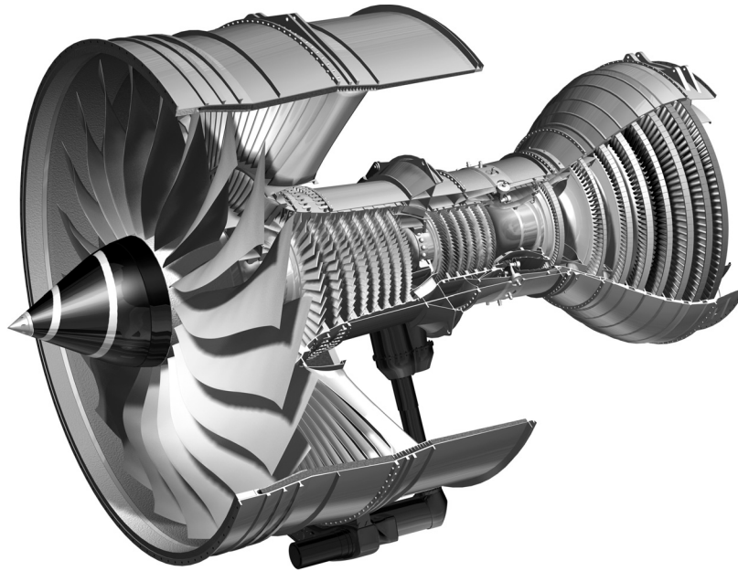
Figura 1.3 Corte transversal de una turbina de motor de aviación.
