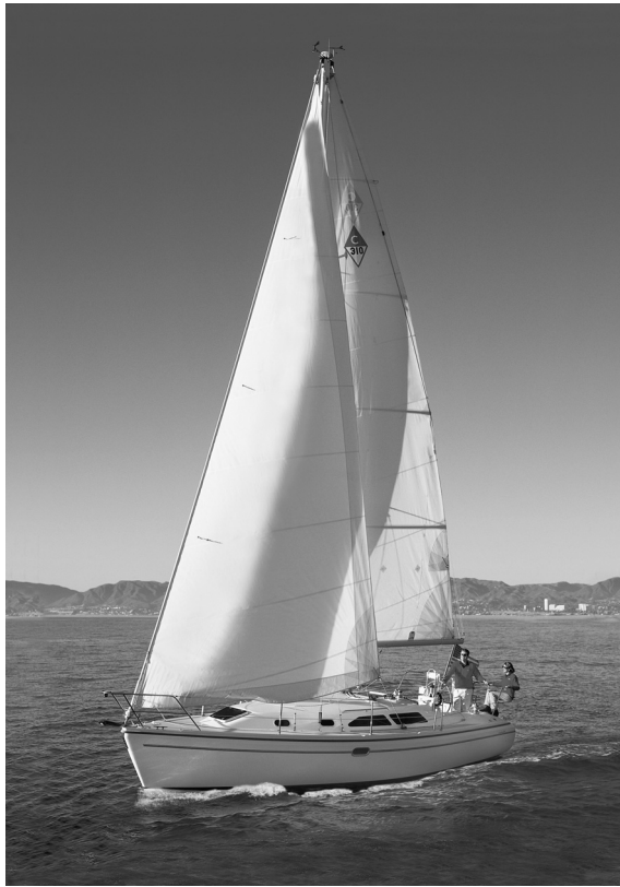
Figura 1.5 Un yate de recreo, con casco de material compuesto (GFRP), mástil de aleación de aluminio y velas de fibra sintética de polímero.
