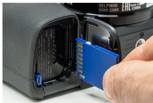
Abbildung 1.22: Das Fach für die Speicherkarten finden Sie an der \alpha 6100 an der Unterseite neben dem Batteriefach. Die Speicherkarte wurde hier durch Verdeutlichung nur halb eingeschoben.
