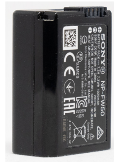
Abbildung 1.21: Sony Original-Akku NP-FW50 mit 7,3 Wh
