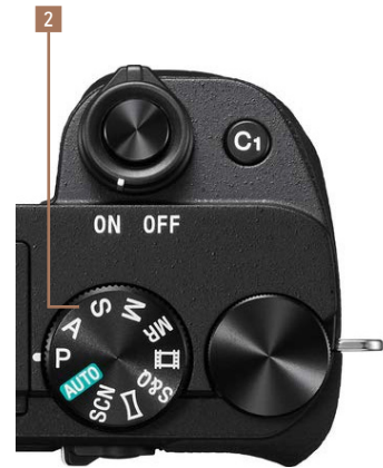
Abbildung 1.9: Moduswahlknopf 2 der α6100 (Foto: Sony)
