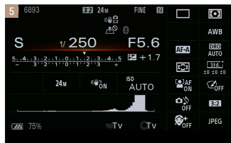
Abbildung 1.17: Die verschiedenen Monitoranzeigen im Vergleich: 1 »Grafikanzeige«, es wird zusätzlich eine Grafik für Blende und Belichtungszeit eingeblendet. 2 »Alle Infos anz.«, hier erhalten Sie den maximalen Informationsgehalt. 3 »Daten n. anz.«, nur die nötigsten Informationen werden angezeigt. 4 »Histogramm«, ein solches wird unten rechts eingefügt. 5 »Für Sucher«, hier werden Informationen ohne Live-View-Bild angezeigt.
