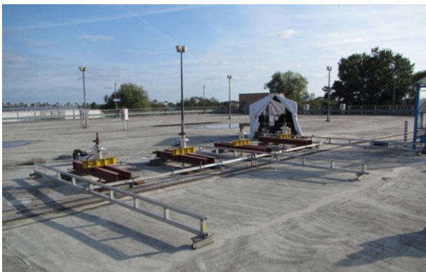
Abb. 14: Lasteinleitung und Messbasis (Nachweis Kragplatte)
