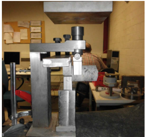
Bild 16: AMPA - Universität Kassel Amtliche Materialprüfanstalt für das Bauwesen Scherfestigkeitsvergleich Testaufbau [6]
