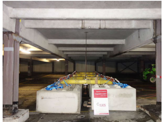
Abb. 7: Gegengewichte (55,2 t) mit Hydraulikpressen und Zugstangen
