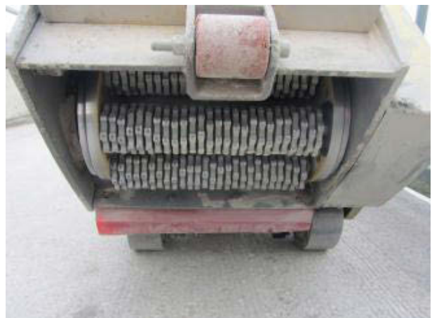
Bild 11: Lamellenwalzen einer Lamellenfräse
