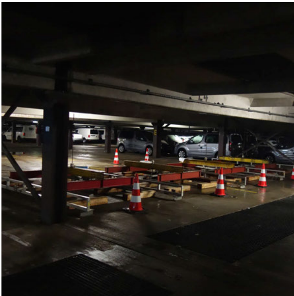
Abb. 6: Lastverteilungstraversen und Messbasis zur Durchbiegungsmessung
