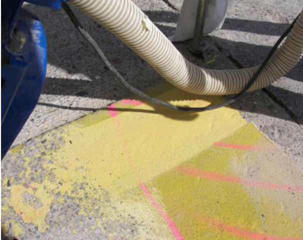
Bild 4: Versuchsergebnis, die Beschichtung nur mit Kugelstrahlen abzutragen
