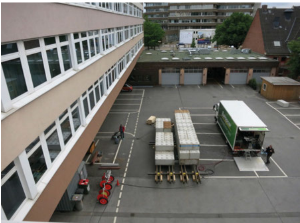
Abb. 10: Tiefgaragendecke mit Belastungsvorrichtung
