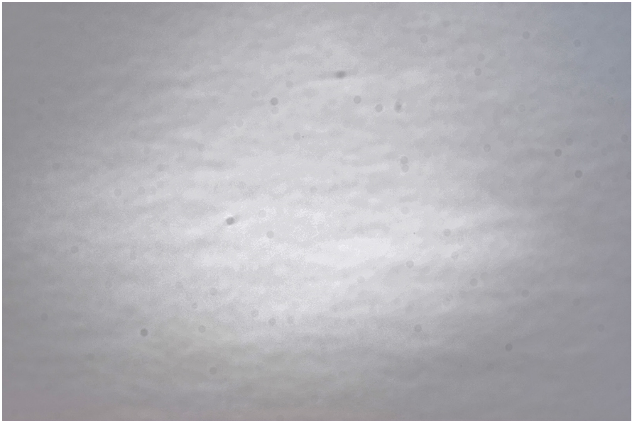
Abbildung 14: Staubflecken auf dem Sensor – sichtbar gemacht. Dieser Sensor muss dringend gereinigt werden.
