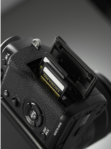
Abbildung 13: Die X-T3 kann auf zwei SD-Speicherkarten gleichzeitig aufnehmen. Wenn Sie maximale Leistung brauchen, sollten Sie schnelle UHS-II-Karten verwenden.
