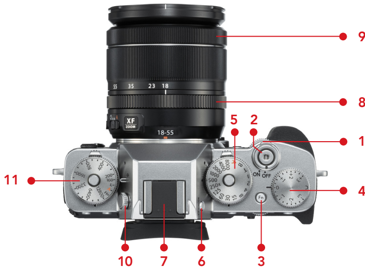
Abbildung 2: Draufsicht der X-T3 (mit XF18-55mmF2.8-4 R LM OIS-Objektiv): Ein-/Aus-Schalter (1), Auslöser (2), Fn-Taste (3), Belichtungskorrekturrad (4), Belichtungszeitwahlrad mit darunterliegendem Belichtungsmessungsmodus-Einstellrad (5), View-Mode-Taste (6), Blitzschuh (7), Blendenring (8), Fokusring (9), Dioptrieneinstellrad (10), ISO-Einstellrad mit darunterliegendem DRIVE-Einstellrad (11)
