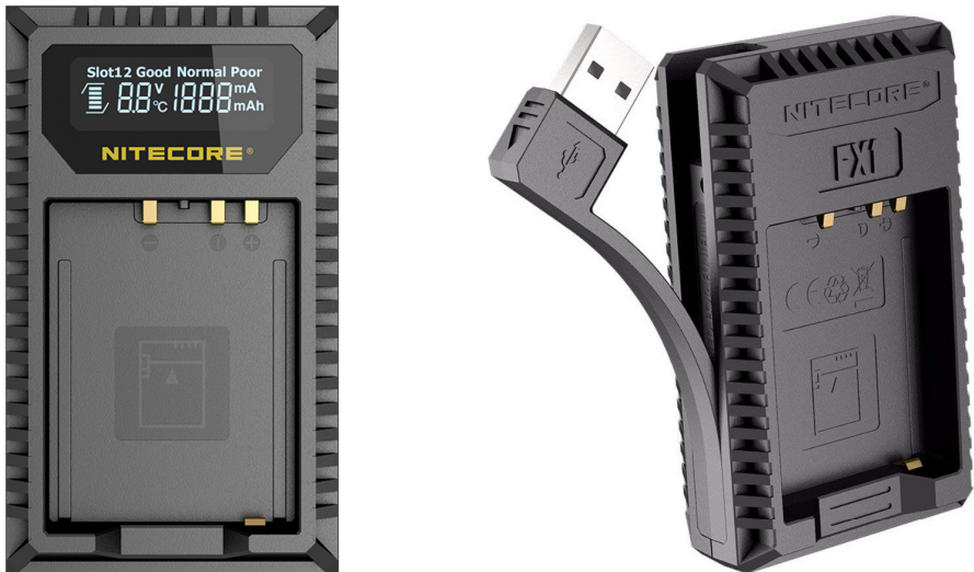
Abbildung 7: Mein persönlicher Favorit bei den Ladegeräten für unterwegs ist das Nitecore FX1 [2] mit zwei Steckplätzen und Statusanzeige (links). Es kann an jeden USB-A-Anschluss (rechts) angeschlossen werden und lädt die Originalakkus NP-W126 und NP-W126S von Fujifilm mit Temperaturüberwachung auf.
