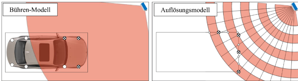
Bild 2: Darstellung zweier phänomenologischer Modellansätze. Im linken Schaubild werden Radardetektionen aufgrund sichtbarer charakteristischer Rückstreuern gebildet. Das Auflösungsmodell in der rechten Darstellung erzeugt Radardetektion (kariert) sofern Schnittpunkte (weiß) nahe an diskreten Auflösungsgridpunkten liegen.
