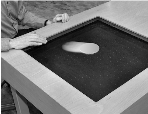
Abb. 2.2 Mitmach-Station: Luftkissen-Tisch. Mit modernen Mitteln, durch eine Art Luftkissentechnik, kann man dem Newton'schen Ideal der gleichförmig geradlinigen Bewegung nahe kommen. Wenn durch die regelmäßig angeordneten kleinen Löcher einer Tischfläche von unten Luft geblasen wird, gleitet eine leichte Scheibe fast reibungslos darüber. Einmal angestoßen, bewegt sie sich zunächst ohne erkennbare Verzögerung auf gerader Linie. Stößt sie gegen den Rand, dann prallt sie zurück und nimmt ihre nahezu gleichförmig geradlinige Bewegung wieder auf. Erst nach einiger Zeit kommt sie langsam zum Stillstand, da trotz Reibungsverminderung kleine Bremskräfte wirken. (© TECHNOSEUM, Foto: Klaus Luginsland)
