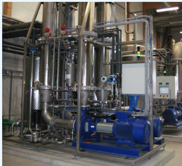
Seite 74: Ultrafiltration von Brüdenkondensaten aus der Klärschlammverbrennung mit keramischen Rohrmembranen
