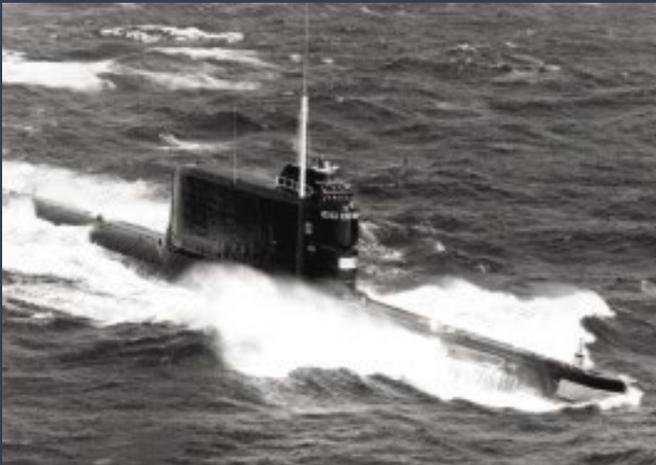
**RAKETENTRÄGER** Das in den späten 1950er-Jahren gebaute, dieselelektrisch angetriebene Sowjet-U-Boot der Golf-II-Klasse erreichte Geschwindigkeiten von 17 Knoten (31 km/h) über und 12 Knoten (22 km/h) unter Wasser. Es war mit drei nuklearen Kurzstreckenraketen mit einer Reichweite von 150 Kilometern bestückt.
