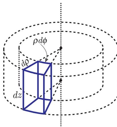
Figura 1.18. Diferencial de volumen en coordenadas cilíndricas
