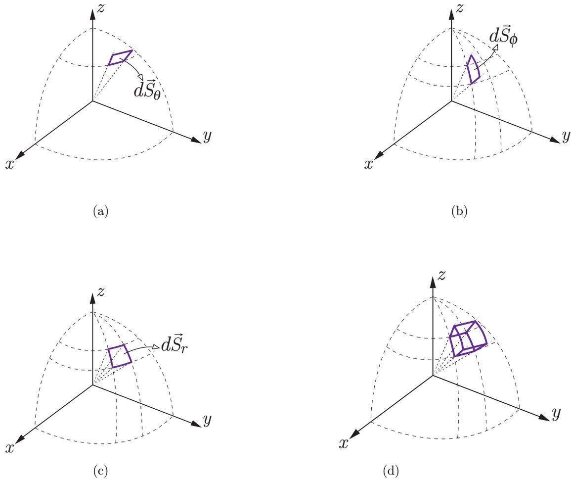
Figura 1.21. a) Diferencial de superficie en dirección  $\hat{u}_\theta$ . b) Diferencial de superficie en dirección  $\hat{u}_\phi$ . c) Diferencial de superficie en dirección  $\hat{u}_r$ . d) Diferencial de volumen en coordenadas esféricas
