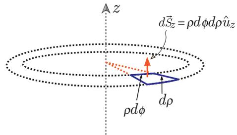
Figura 1.16. Diferenciales de superficie en coordenadas cilíndricas
