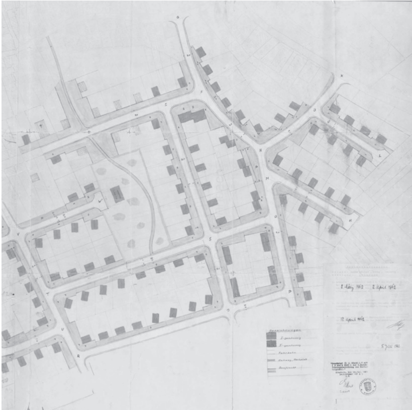
Abb. 1: Auszug aus einem Baufluchtenplan der Gemeinde Sulzfeld/Baden aus dem Jahr 1962. Bauflucht wird als Bezeichnung für die in einer Linie (Baufluchtenlinie) verlaufende Stellung von Baukörpern verwandt. Der Plan zeigt darüber hinaus die geplanten Wege/Parkplätze und die zulässige Geschossigkeit von Baukörpern.
