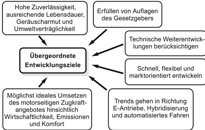
**Abb. 1.5** Übergeordnete Entwicklungsziele bei Fahrzeuggetrieben
