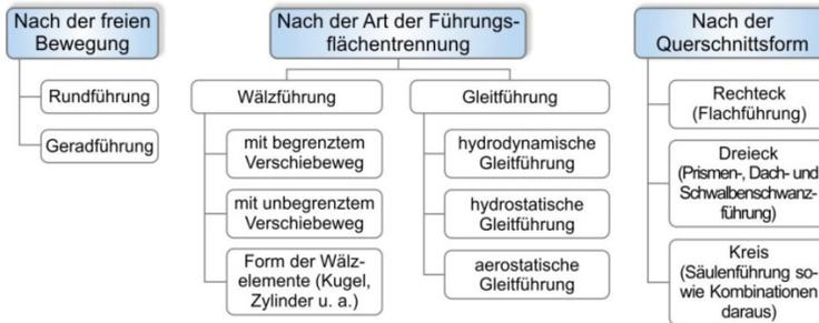
**Bild 2-2** Klassifizierung von Werkzeugmaschinen-Führungen
