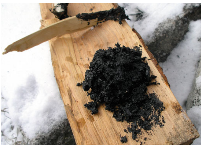
Abb. 1.1 Im Eintopfverfahren hergestelltes Birkenpech (Foto: Jorre, Wikimedia Commons).
