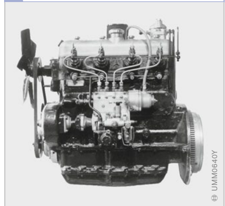
6 Bosh-Reiheneinspritzpumpe am Motor des Mercedes 260D
