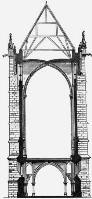
6, 7 Paris, Sainte-Chapelle, 1243–1248 von Pierre de Montereau als königliche Hofkapelle erbaut, Querschnitt und Grundriß, linke Hälfte Untergeschoß, rechte Hälfte Obergeschoß.
