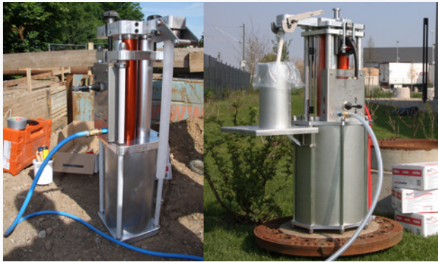
44 Stutzensanierung: 4K-Pastenmischanlage 1.0 auf der Baustelle (links) und 4K-Pastenmischanlage 2.0 (rechts)
