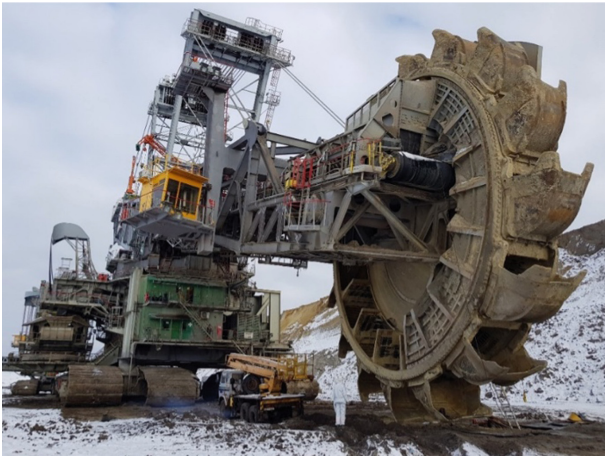
Fig. 1. SchRs4600 bucket-wheel excavator
