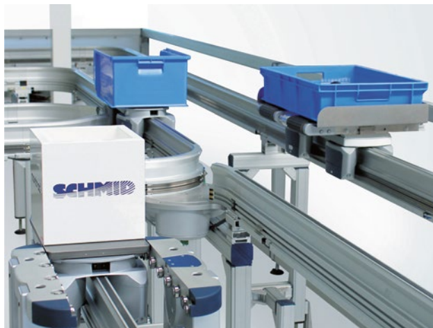
Abb. 1.12 Elektrotragbahn mit Kleinbehälter (Foto: montratec)
