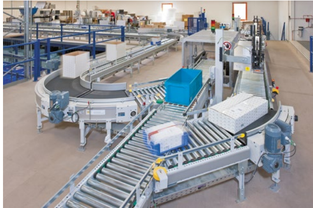
Abb. 1.6 Förderanlage für leichte Stückgüter (Foto: psb intralogistics)
