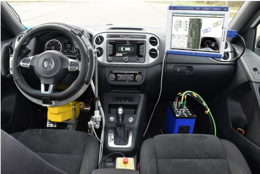
Bild 1: Eingebautes Komplettsystem Cockpitansicht
