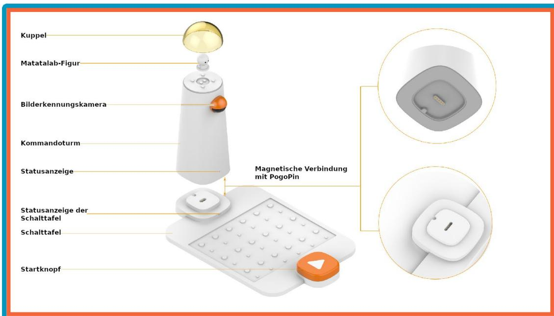
Wenn die Code-Blöcke auf der Schalttafel bzw. Control Board platziert werden und der orangefarbene Start-Button oder Start-Knopf gedrückt wird, liest der Kommandoturm mittels Bilderkennung (dabei wird ein Bild der Blöcke gemacht) den Code auf den Blöcken. Über die Bluetooth-Verbindung wird der Code an den Roboter gesendet.
