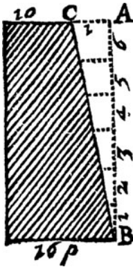
Abb. 2.11 Bemessung einer Stützmauer nach Bullet (1691, S. 173).
