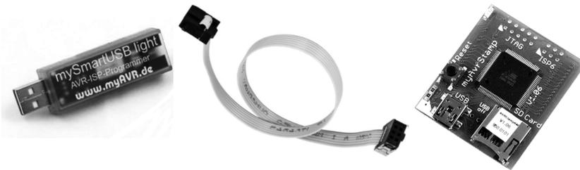
**Abb. 1-2** Programmieradapter und Zielsystem
