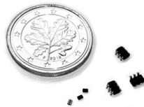
**Abb. 1-4** *8-Bit-Controller im Vergleich zu einer 1-Cent-Münze*
