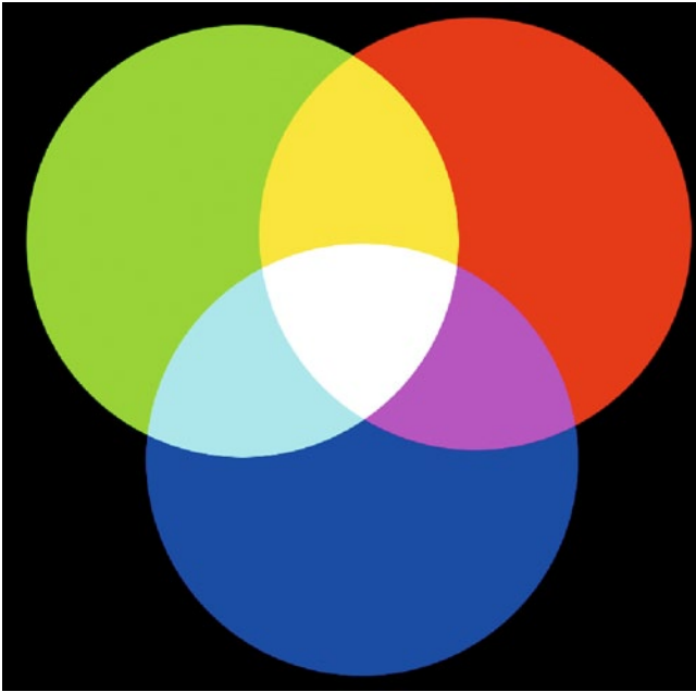
Abb. 1.19 Schematische Darstellung der Farbmischung im RGB-Modell
