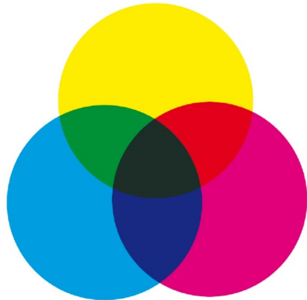
Abb. 1.20 Schematische Darstellung der Farbmischung im CMY-Modell
