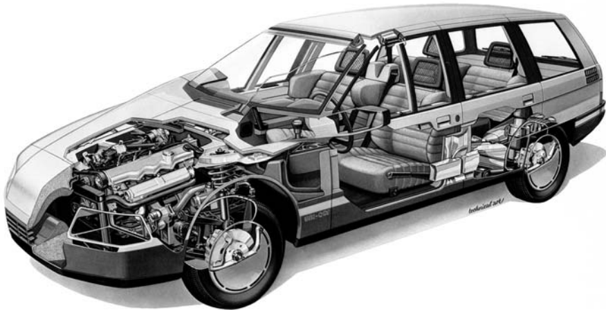
Abb. 1.2 Im Forschungsfahrzeug Uni-Car wurden zahlreiche Maßnahmen zum Fußgängerschutz wie gepolsterte Front-, Hauben- und Scheibenrandbereiche prototypisch umgesetzt (BMFT 1983).
